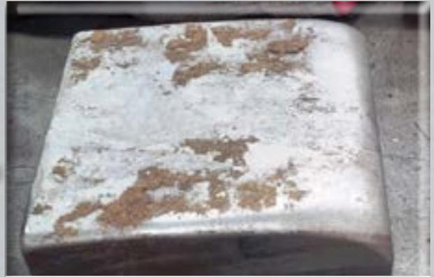
Pastilles de marteaux bimétalliques (durée de vie 2.5 fois supérieure à des pièces protégées par du CARBURE DE TUNGSTEN)
