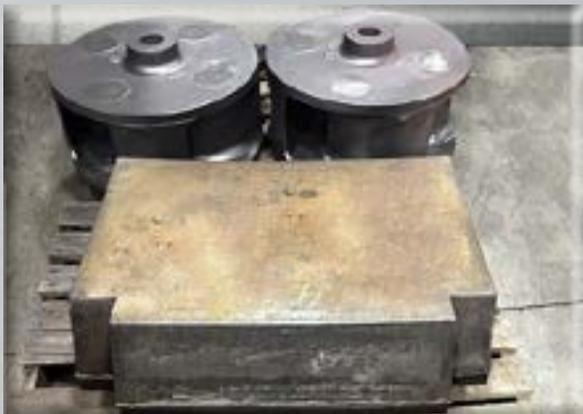
Liner bimétallique pour une chute de SAG Mill et rotors pour des pompes
